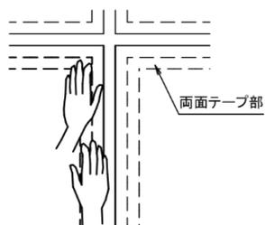
化粧板の位置を決めた後に、両面テープの位置を手で押さえこむようにして、化粧板を十分に圧着させて下さい。30～40分経過後、再度表面より十分に圧着して下さい。
