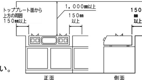
(2) コンロの側面及び背面から化粧板まで150mm以上離せない場合、化粧板とコンロの間に防熱板を設置して下さい。防熱板は、コンロから50mm以上離して下さい。
