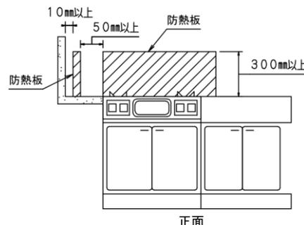
ガスコンロと化粧板との距離が近いと、コンロの熱や、加熱された鍋やフライパン等が触れることで化粧板の表面に変色や焦げが発生する場合があります。特に業務用コンロの場合は強い火力が予想されます。コンロ側面、背面と化粧板とは200mm以上間隔を取るか、防熱板を設置して下さい。以上の条件を満たしても、火が直接化粧板に当たらないようにご注意下さい。(変色や焦げが発生しても不燃性能には影響ありません)
