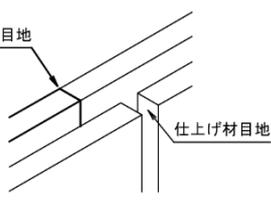
施工図に従い、施工箇所の下地に化粧板の割付けを行ってください。割付けの際、下地の目地と化粧板の目地が重ならないようにしてください。
